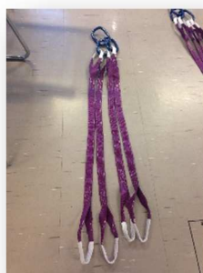
Båndstropper direkte sydd i koblingsløyker
