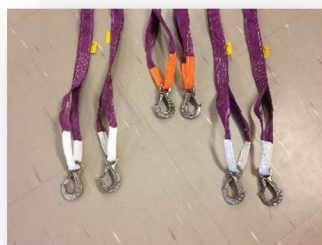
6-part med fargekoder på stroppene for å sikre korrekt bruk
