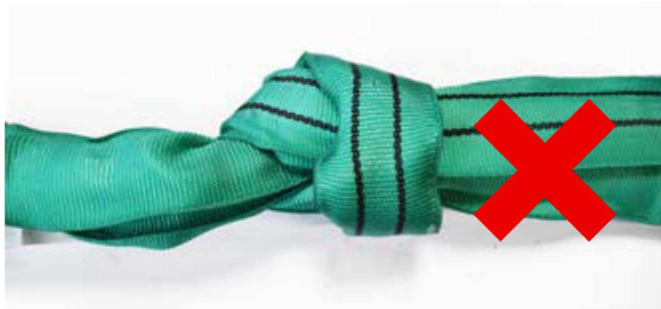
Figur 2 Knytning av stropper er ikke tillatt
